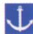
E6 Autorisation d'ancrer du côté de la voie où le signal est placé
